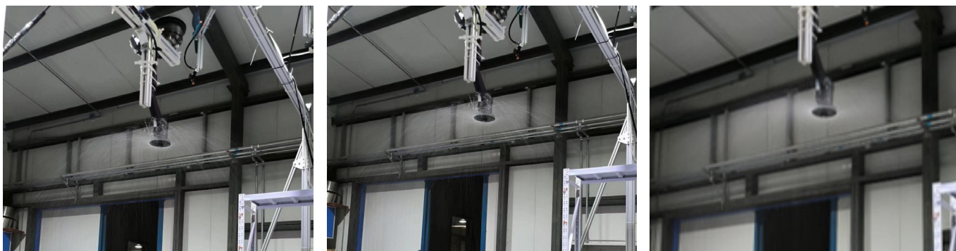
图 12 单旋翼下洗气流场作用下雾滴粒径谱测试现场
