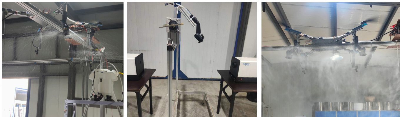
图 14 无人机下洗气流场雾滴粒径分布测试现场现场
