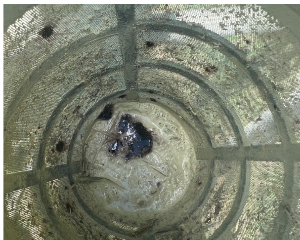
图 65 使用农药混配导致凝结堵塞滤网
